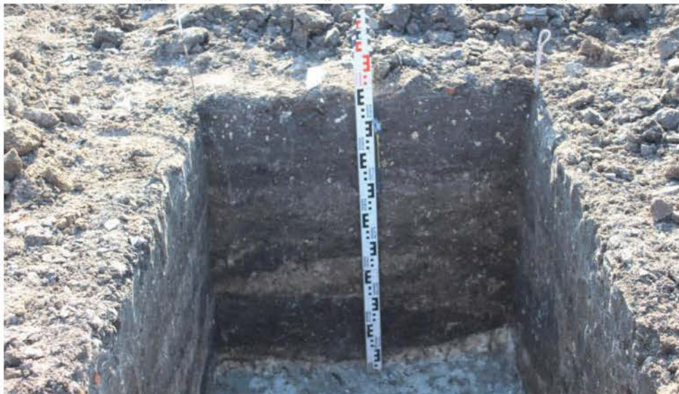
Рис. 35. Объект: «Рекультивация свалки, расположенной по адресу: Ростовская область, Неклиновский район, с. Покровское ( в южной части села), ул. О. Кошевого, полигон твердых бытовых отходов». Шурф 1. Стратиграфический разрез южного борта. Вид с З.
